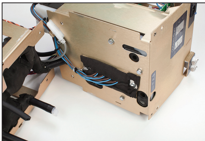
Slika 8-49 Spremnik i grijač s naznakom vezica kabela koje treba ukloniti (2. korak)
