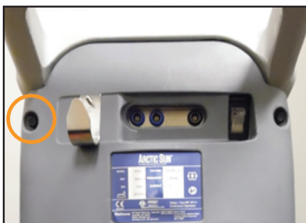
Slika 8-72 Uklanjanje vijaka (1. korak)
