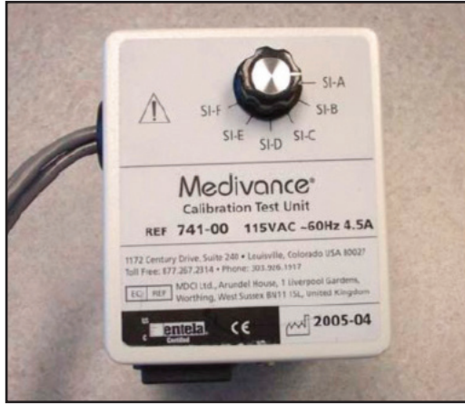
Şek. 9-1 Kalibrasyon Test Ünitesi
