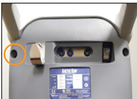
Fig. 8-72 Scoateți șuruburile (pasul 1)
