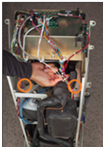
Fig. 8-17 Scoateți două șuruburi (pasul 2)
