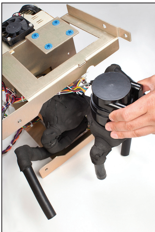
Fig. 8-31 Scoateți cu grijă pompa de amestecare (pasul 5).
