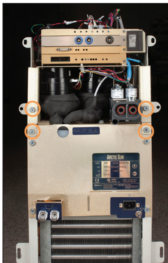
Fig. 8-16 Scoateți patru șuruburi (pasul 1)
