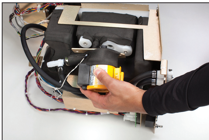
Fig. 8-42 Îndepărtați Pompa de răcire
