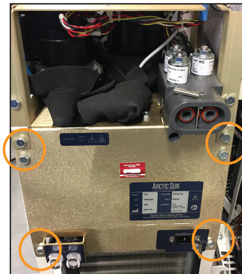
Fig. 8-36 Îndepărtați cele șase șuruburi (pasul 3)
