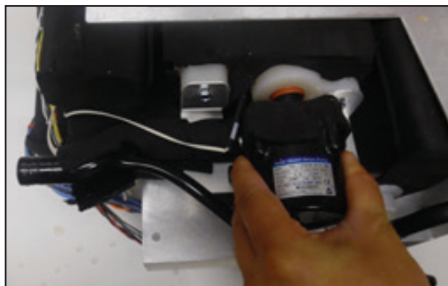
Fig. 8-47 Reinstalați pompa (pasul 6) (două vederi)
