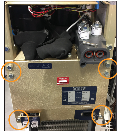
Fig. 8-36 Fjern seks bolter (trinn 1)
