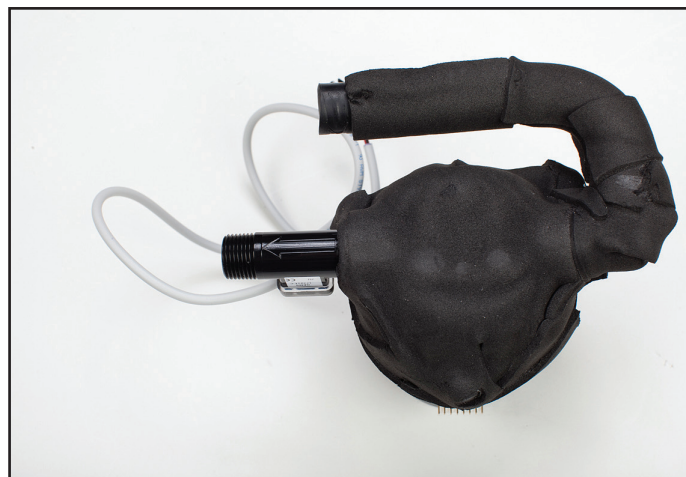
Fig 8-53 Flödesmätare med pil som anger flödesriktningen.; samma riktning som cirkulationspumpens utgång
