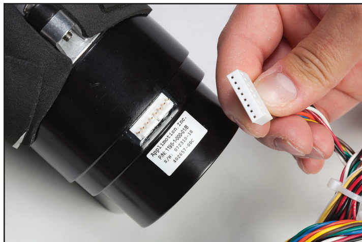
Kuva 8-32 Kuva pumpun liittimestä ennen kytkemistä (yllä), kytkettynä, mutta asetettu väärin yhden nastan näkyessä, (alla vasemmalla) ja oikein paikoillaan (alla oikealla)
