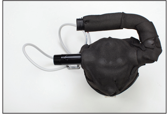
Kuva 8-53 Virtausmittari ja nuoli, joka osoittaa virtauksen suunnan, joka on samaan suuntaan kuin kiertopumpun ulostulo
