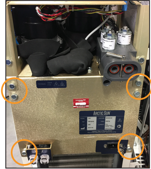
Kuva 8-36 Irrota kuusi pulttia (vaihe 3)
