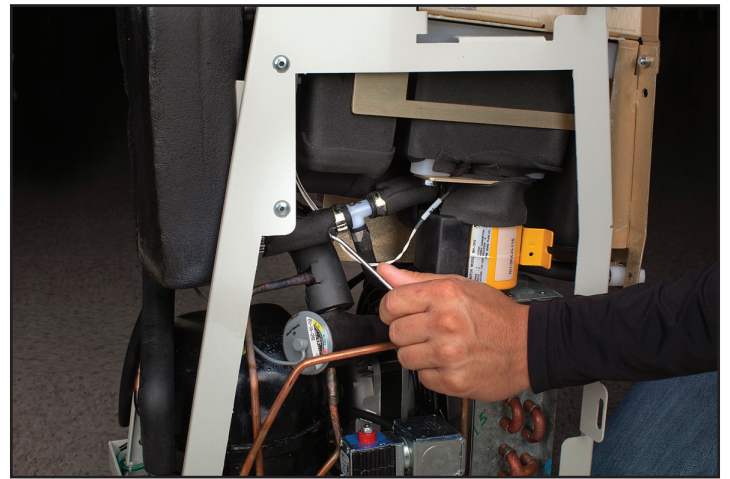
Kuva 8-21 Avaa pikaliitin (vaihe 3, verkkovirtapumppu)
