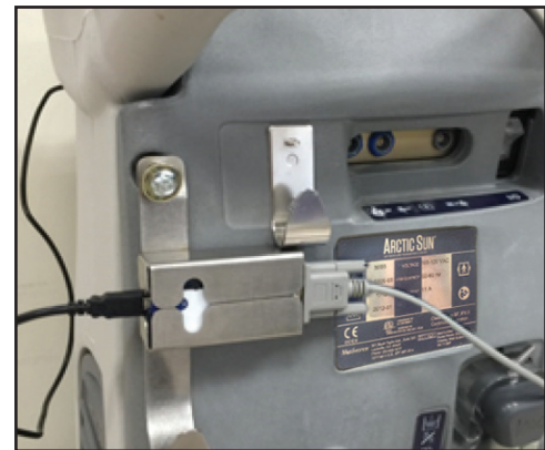
Kuva 8-74 Aseta TIM ja kytke kaapelit (vaiheet 3–5)
