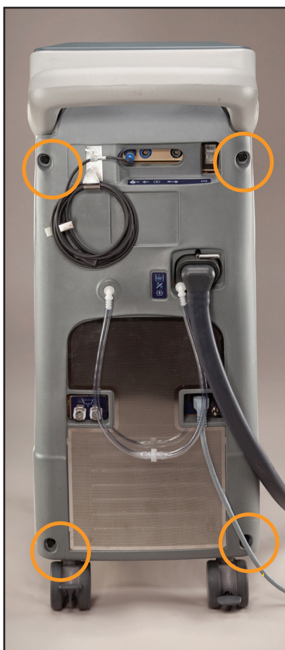
Εικ. 8-10 Το οπίσθιο πάνελ στο οποίο υποδεικνύονται τα μπουλόνια που πρέπει να αφαιρεθούν (Βήμα 2, αριστερά)
