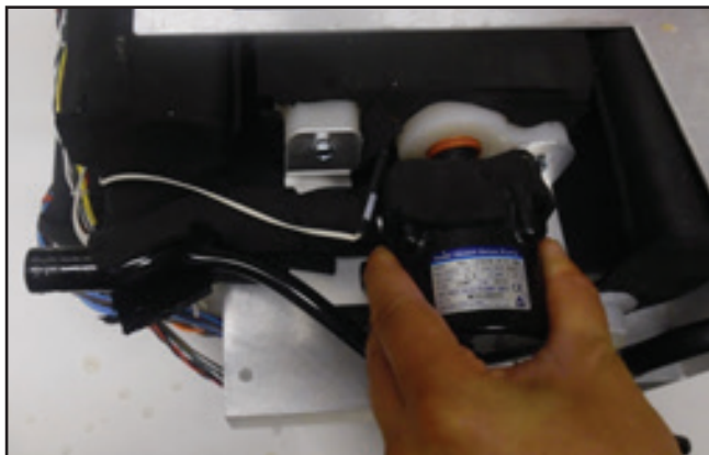
Εικ. 8-47 Επανεγκατάσταση αντλίας (Βήμα 6) (δύο όψεις)
