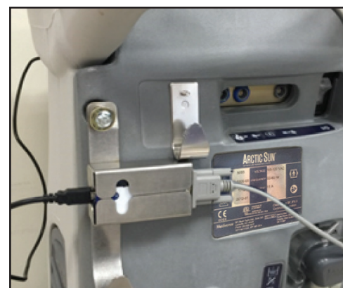
Εικ. 8-74 Εισαγωγή TIM και σύνδεση καλωδίων (Βήματα 3-5)
