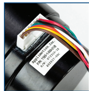
Εικ. 8-32 Απεικόνιση του συνδετήρα της αντλίας πριν από τη σύνδεση (πάνω), συνδεδεμένος αλλά χωρίς να είναι σωστά τοποθετημένος με έναν ακροδέκτη εκτεθειμένο (κάτω αριστερά) και σωστά τοποθετημένος (κάτω δεξιά)
