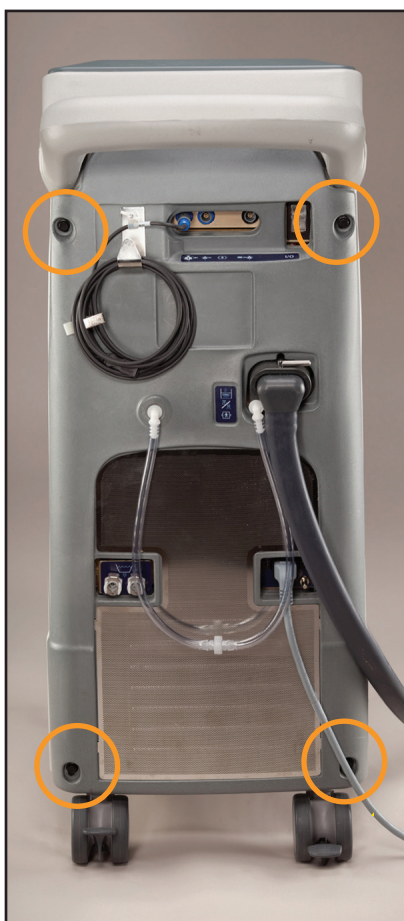
Abb. 8-10 Rückwand mit Angabe der zu entfernenden Schrauben (Schritt 2, links)
