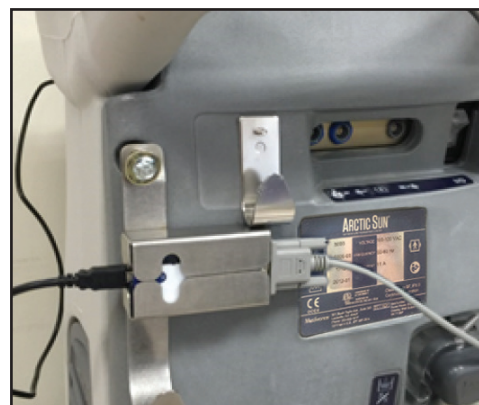
Abb. 8-74 Einsetzen des Übertragungsschnittstellenmoduls und Anschließen der Kabel (Schritte 3-5)
