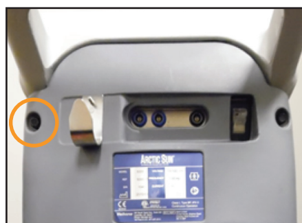
Abb. 8-72 Entfernen der Schraube (Schritt 1)
