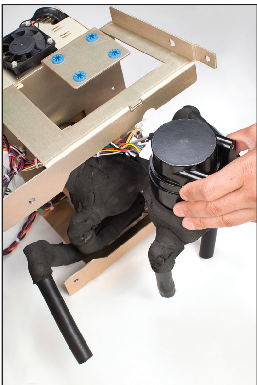
Abb. 8-31 Entfernen Sie die Mischpumpe vorsichtig (Schritt 5).
