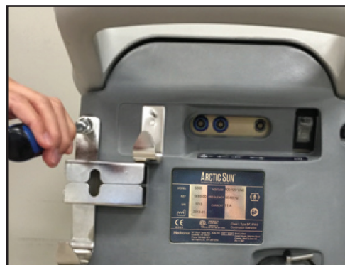
Abb. 8-73 Sichern der Halterung (Schritt 2)
