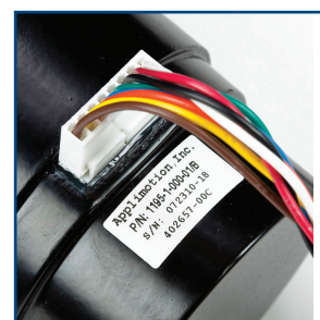
Abb. 8-32 Abbildung des Pumpensteckers vor dem Anschließen (oben), angeschlossen, aber aufgrund eines freiliegendes Stifts falsch eingesetzt (unten links), und richtig eingesetzt (unten rechts)
